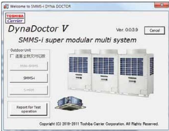
**DynaDoctor – программа для диагностики и пусконаладки систем кондиционирования Toshiba**
